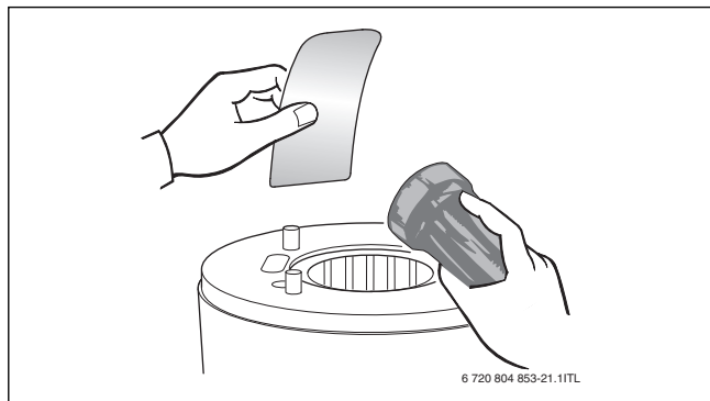
Σχ. 44 Έλεγχος εναλλάκτη θερμότητας για κατάλοιπα
